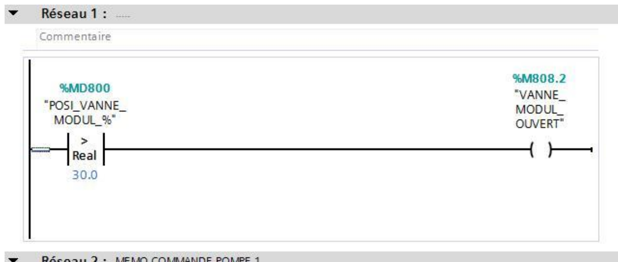
FigureIII. 21 Réseau vanne modulante
