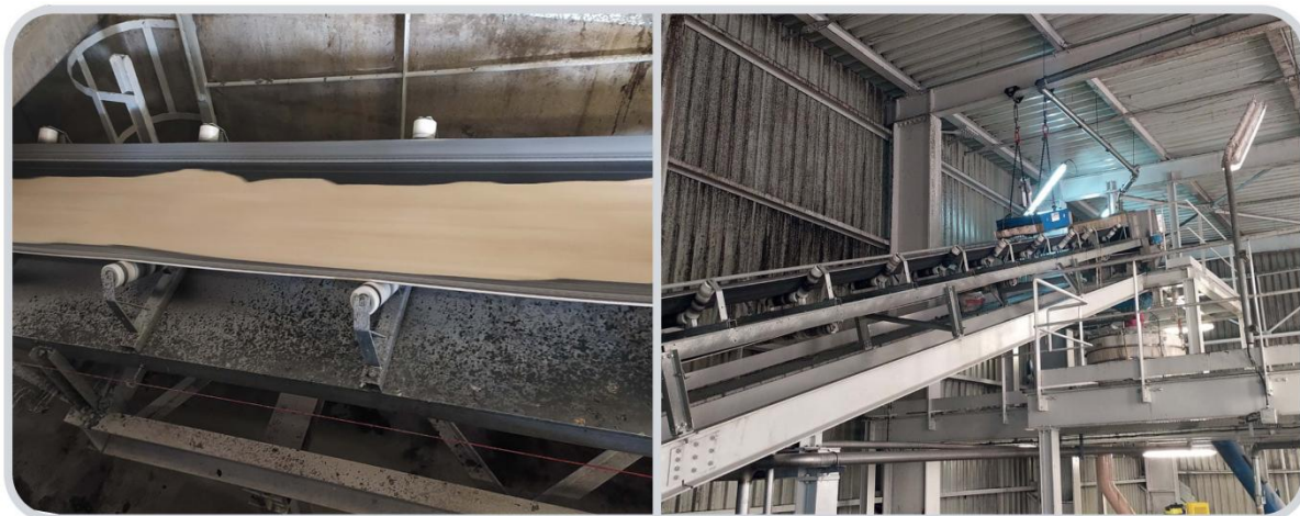
Figure I. 6 Sucre roux sur bande transporteuse pour la séparation métallique et solide (zone 03).
