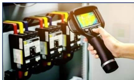
Fig II. 11: La thermographie infrarouge
