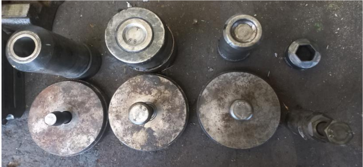
Figure 45 moule et maitre pousseur de la machines BKA3
