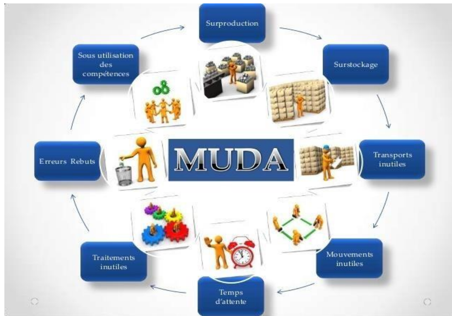
Figure.I. 12: Les mudas d'un processus de production.
