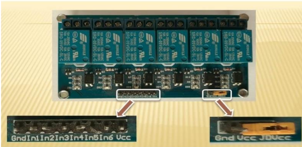
Figure 0-8 Ensemble d'une rampe de relais.
