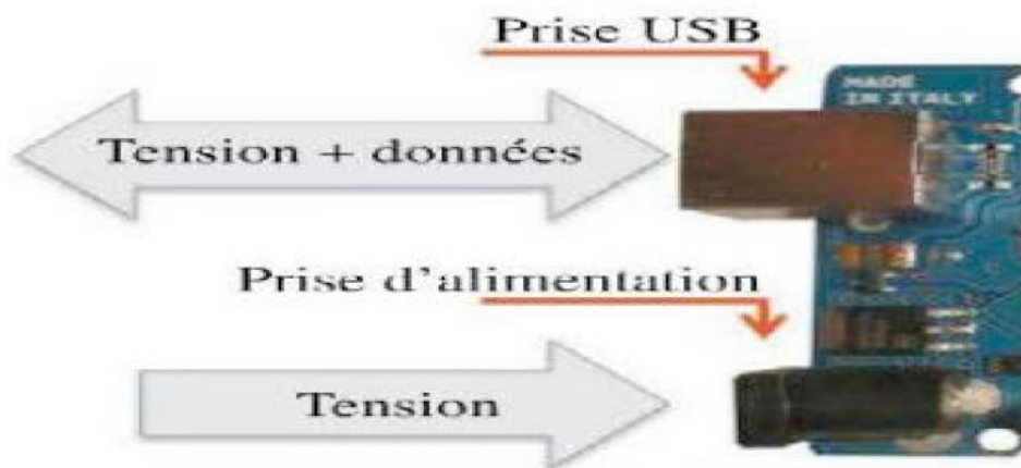
Figure 0-3 Alimentation de la carte Arduino.
