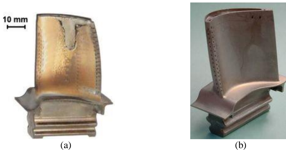
Figure I.14 : Aube sans (a) et avec (b) le refroidissement par film
