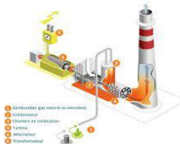
Figure I.2 : Centrale thermique à turbine à gaz
