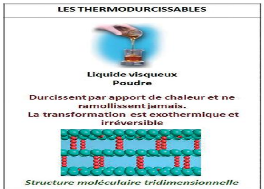
Figure I.7 : Les matrices thermodurcissables
