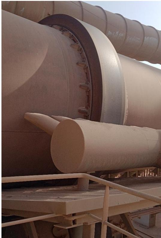
**Figure (I-16) : Bandage d'un four rotatif.**
