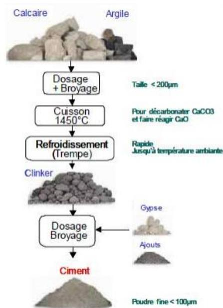
Figure (I-1) : Description des étapes de fabrication du ciment de portland.[2]
