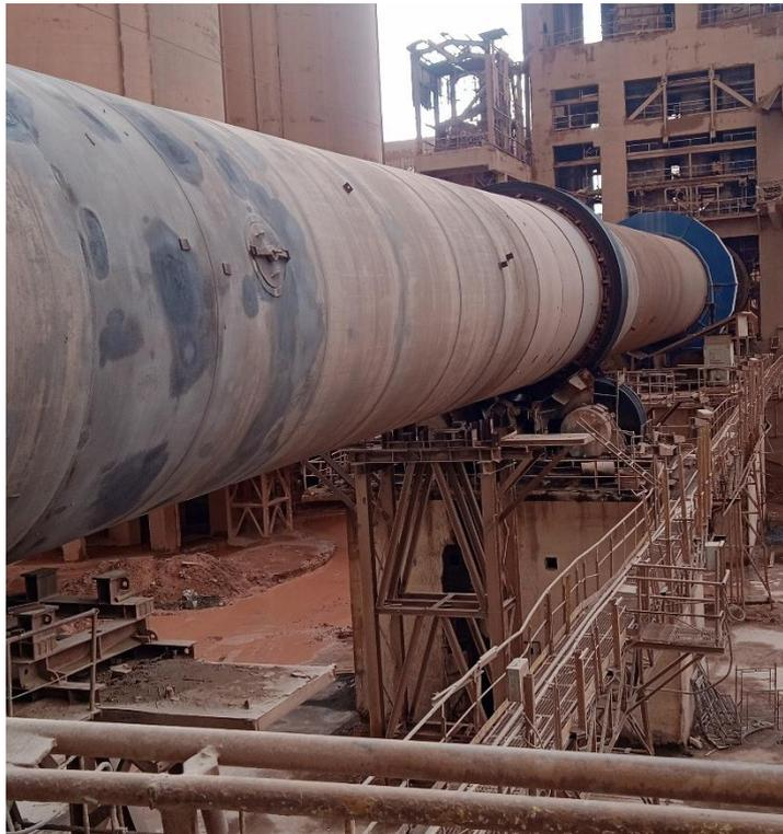
**Figure (I-6) : four rotatif de la cimenterie de Zahana.**
