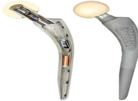
Figure II. 11: Prothèse métallique orthopédique instrumentée
