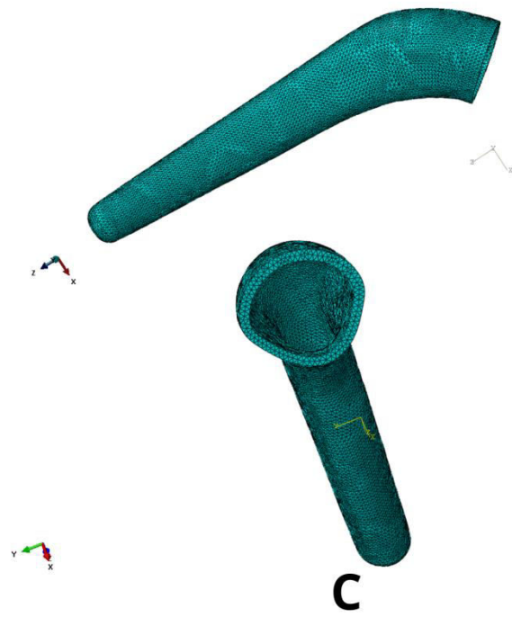
Figure III. 16: Maillage par éléments finis du ciment orthopédique
