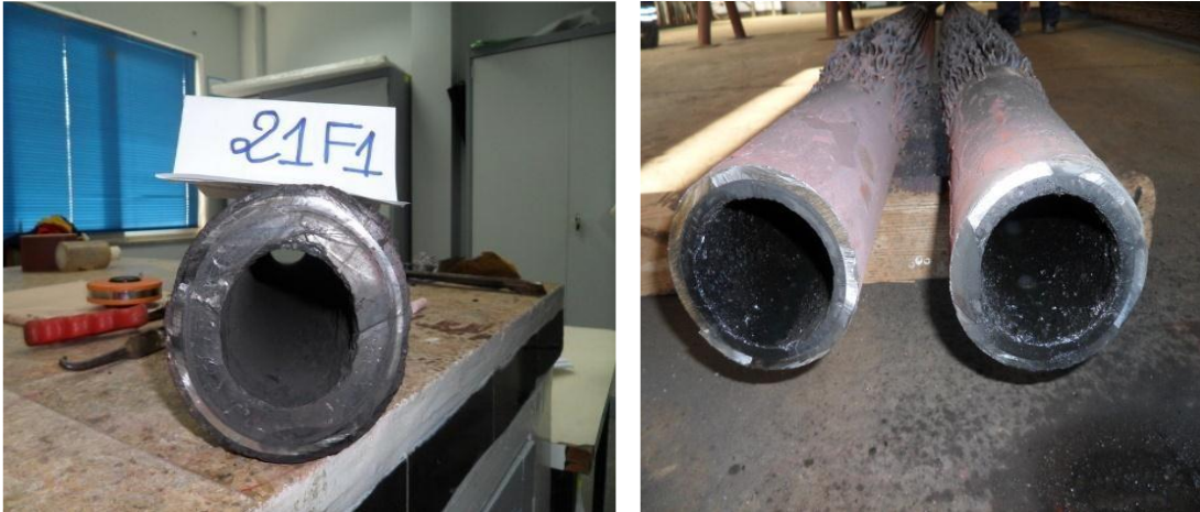
Figure VI.7. Présence d'une couche de coke sur les parois internes des tubes qui varie entre 15 et 20mm
