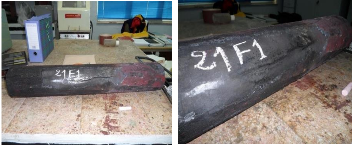
Figure VI.5. Présence d'une fissure dans la partie supérieure du tube N°17 d'une longueur de 200mm
