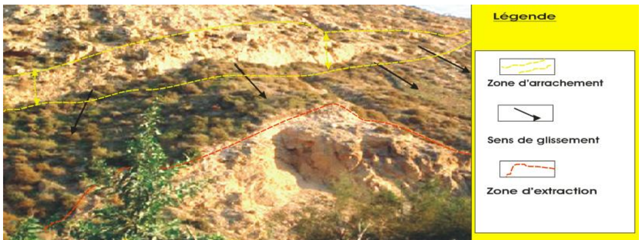
Fig.33 : Glissement déclenché par l’activité anthropique (extraction de sable)
