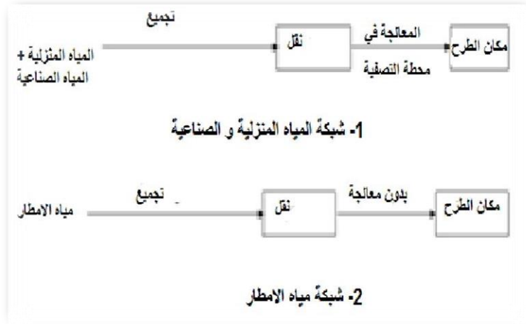
الشكل -08- النظام النصف منفصل 1
