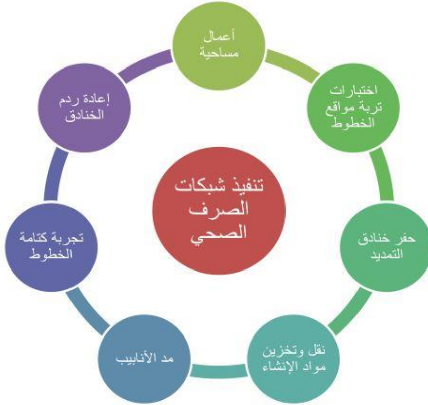
الشكل -18- تنفيذ و إنجاز شبكة الصرف الصحي
