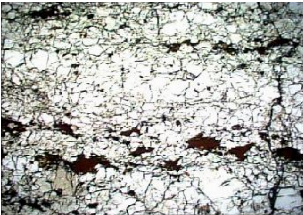
Photo.6 : texture porphyroclastique dans une Lherzolites a spinelle (in Zerka, 2004).
