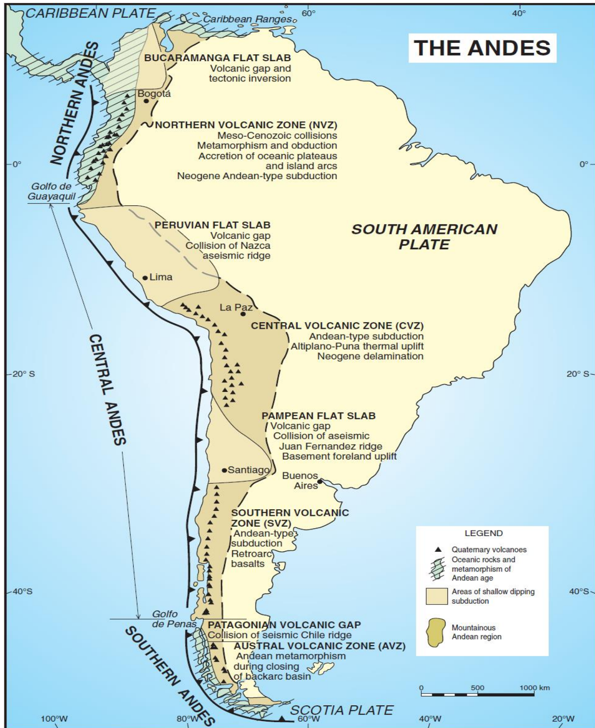
Fig.11 Principaux segments des Andes et des principales zones volcaniques quaternaires et processus tectoniques (modifiés de Ramos, 1999).
