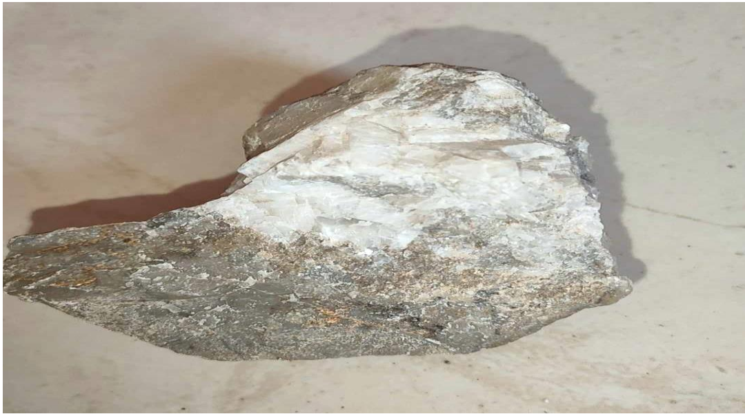
Figure 29: Texture rubanée de deux ou de bandes la barytine et le calcaire
