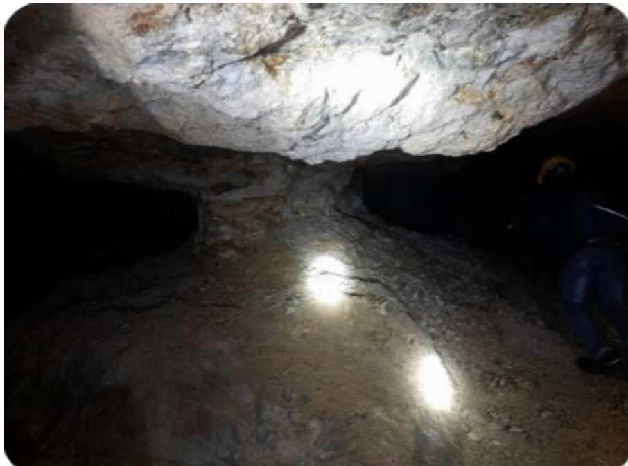
Figure 19: L'exploitation par chambres et piliers
