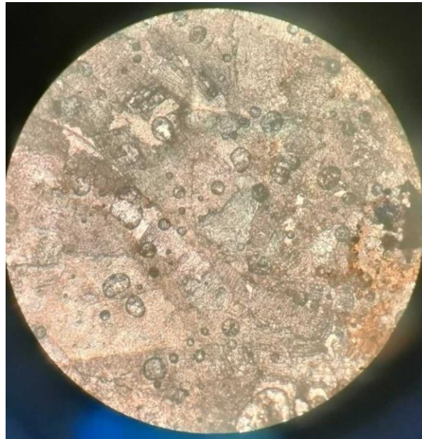
Figure 37: Assemblage de barytine, de calcite et de dolomite (Grx5)
