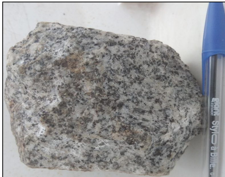
Photo12: Photo d'un granite gris clair de Nedroma, montrant la texture grenue et la composition minéralogique de quartz(Q), de feldspath(Fd) et de biotite (Bio)
