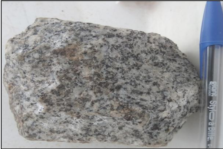
Photo12: Photo d'un granite gris clair de Nedroma, montrant la texture grenue et la composition minéralogique de quartz(Q).
