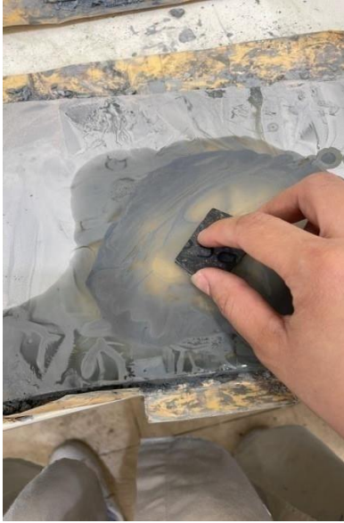
Fig 7 : Polissage du sucre avec l'abrasif grossier
