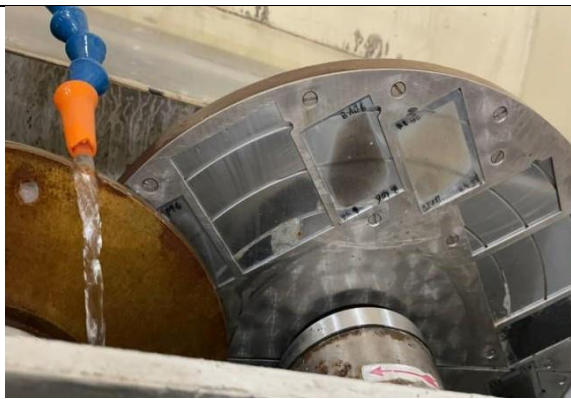
Fig 9 : Nettoyage de lame de la colle restante avec de l'Acétone
