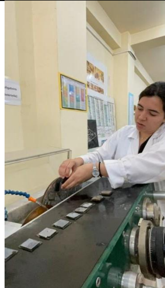
Fig 10 : Amener la lame mince à la bonne épaisseur grâce à la rectifieuse
