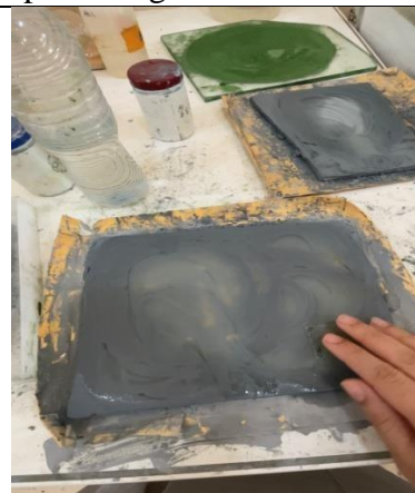
Fig 12 : Finalisation du polissage de la lame
