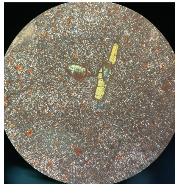
Fig 17 : Coulée phénocristaux d'olivine en LP (Grossissement 5x/0.12)
