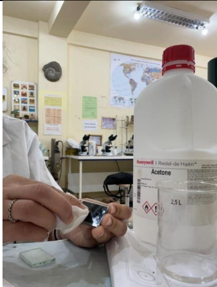
Fig 9 : Nettoyage de lame de la colle restante avec de l'Acétone
