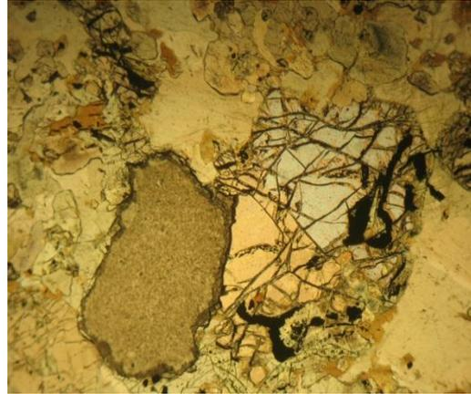
**Photo A** : Section montrant l'olivine craquelée dans les Gabbros à
