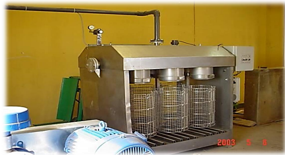
Figure 19 : Unité Séchage des Boues (DRAIMAD) (Document GP1/Z, 2003)
