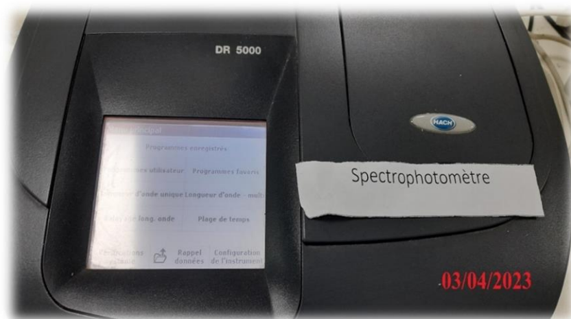
Figure 25 : Spectrophotomètre DR 5000 (MES, Fer, PO_4^{3-} )
