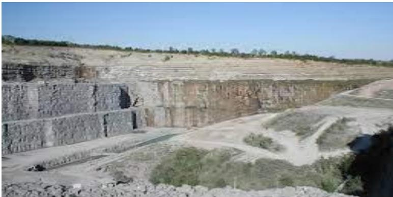
**Photo 1: Exploitation de carrière de calcaire (Gradins)**
