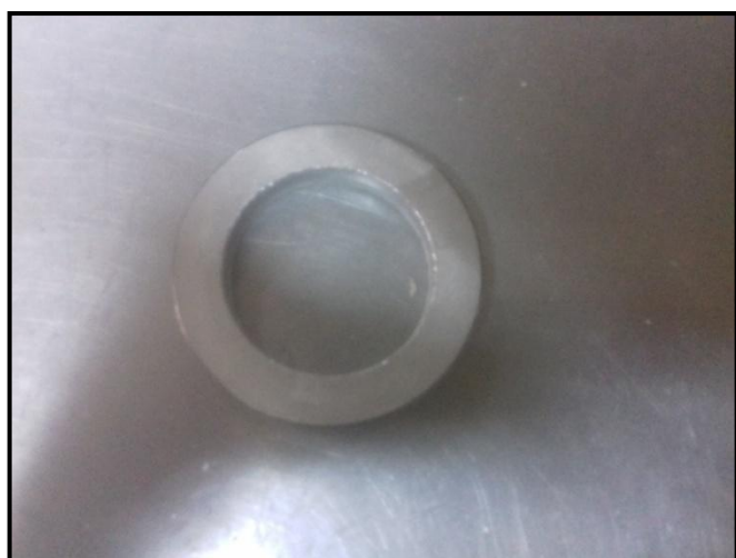
Fig.9 : Anneau en acier qui sert de support a la pastille
