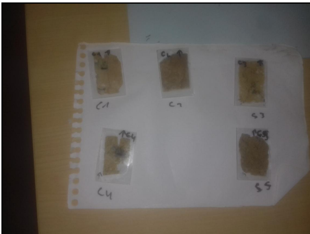
Fig.16 : Le résultat obtenu après le passage à la rodeuse et le polissage final
