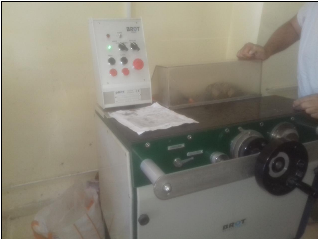
Fig.15: Rodeuse qui sert à la mise à l'épaisseur de la lame mince
