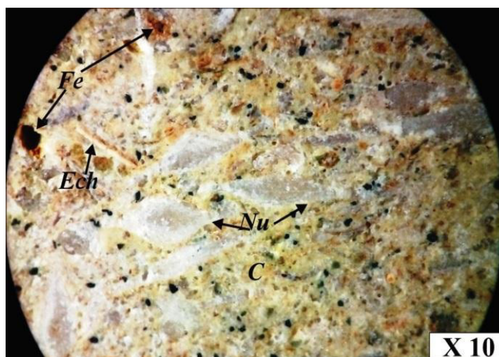
Fig. 10: Section polie de grés calcaires de l'ensemble inférieur de la coupe de Kef Ighoud. Ech : plaque d'oursin ; Nu : nummulite ; C : ciment ; Fe ; concrétion ferrugineuse.
