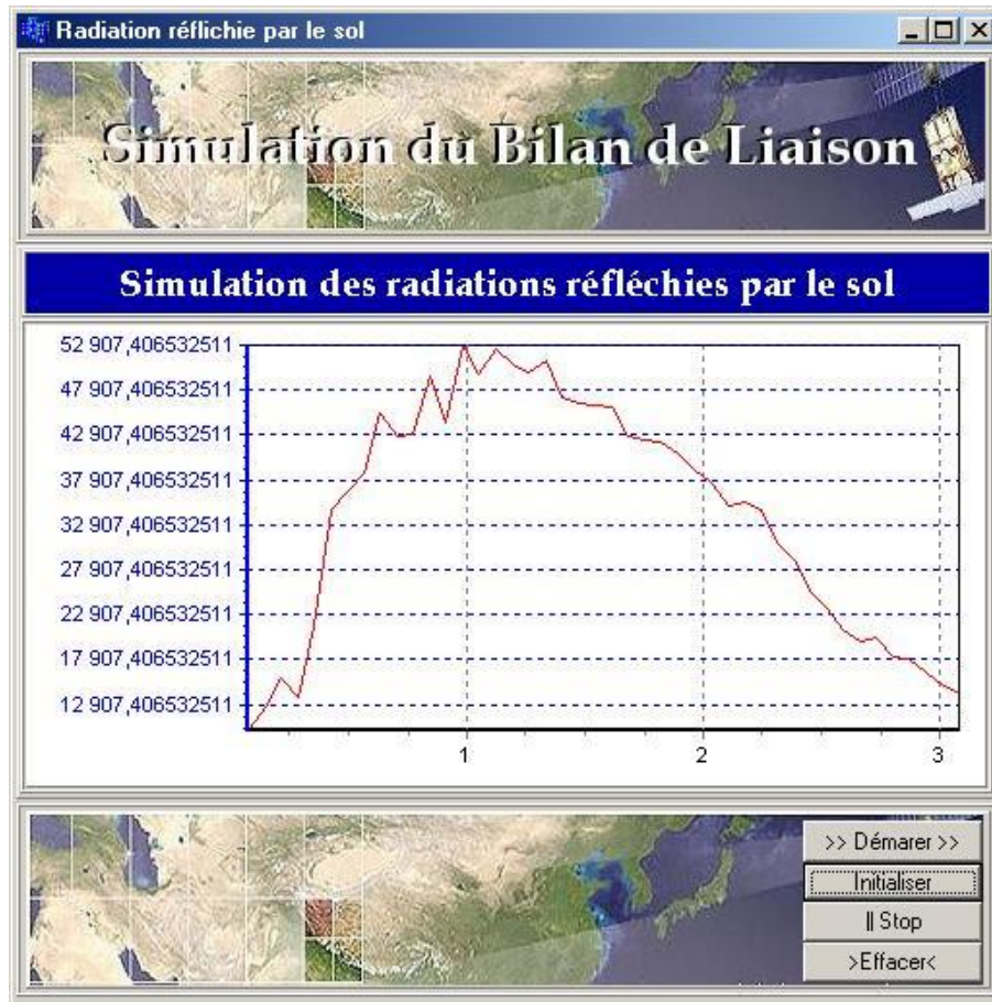
Figure III.3 Radiation réfléchi par de l'eau et atteignant le satellite
