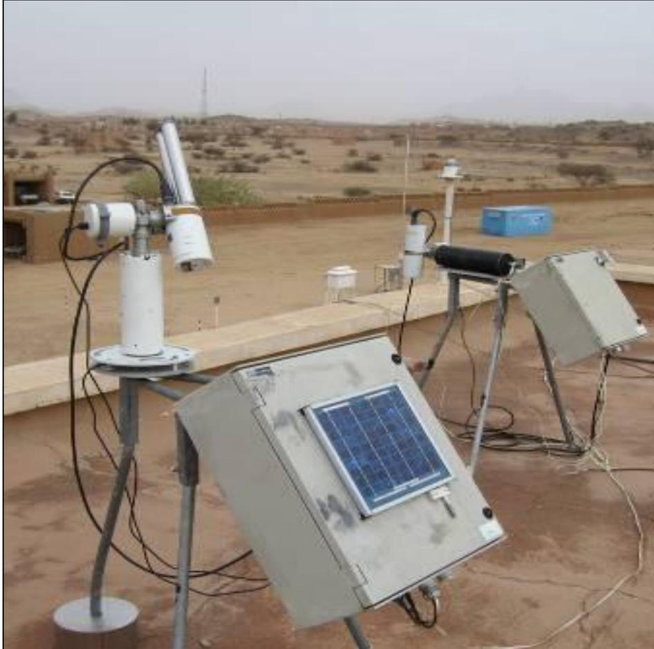
**Figure 2.6 Photomètre solaire**
