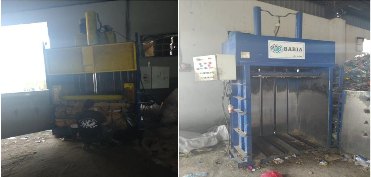
Figure 12 :récupération de la matière recyclé en bal (la press). 16 juin 2020
