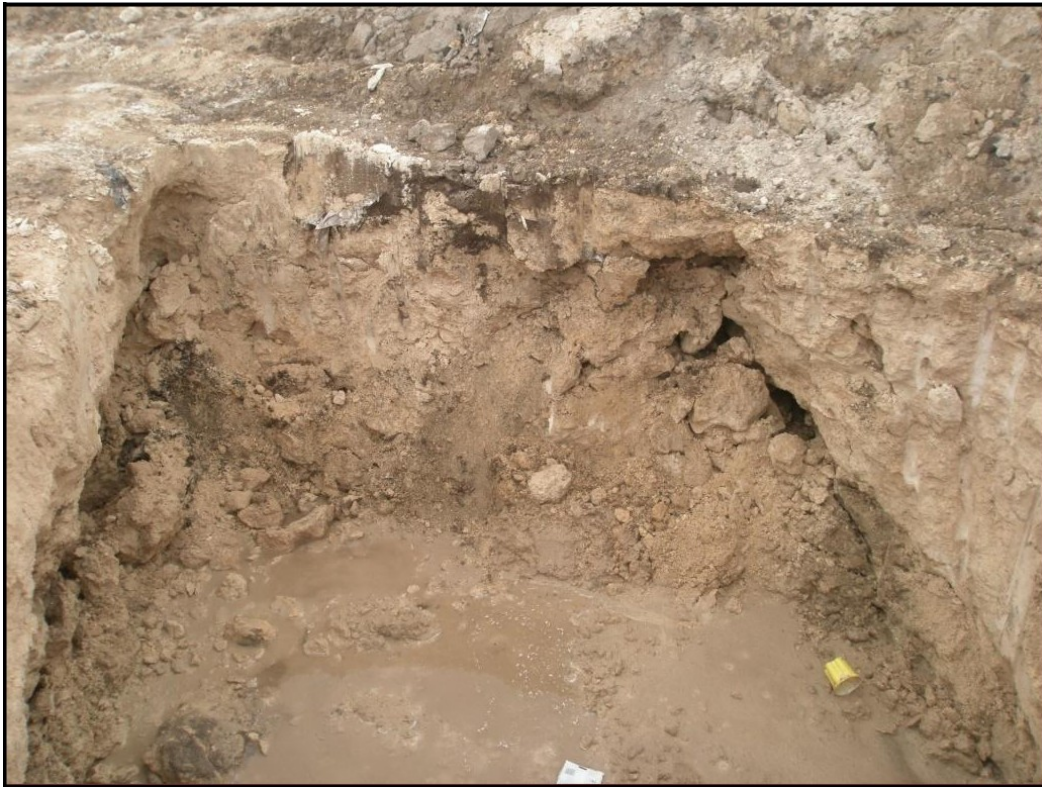
Fig. 28 - Cavité mise à jour dans les limons à incrustations de gypse
