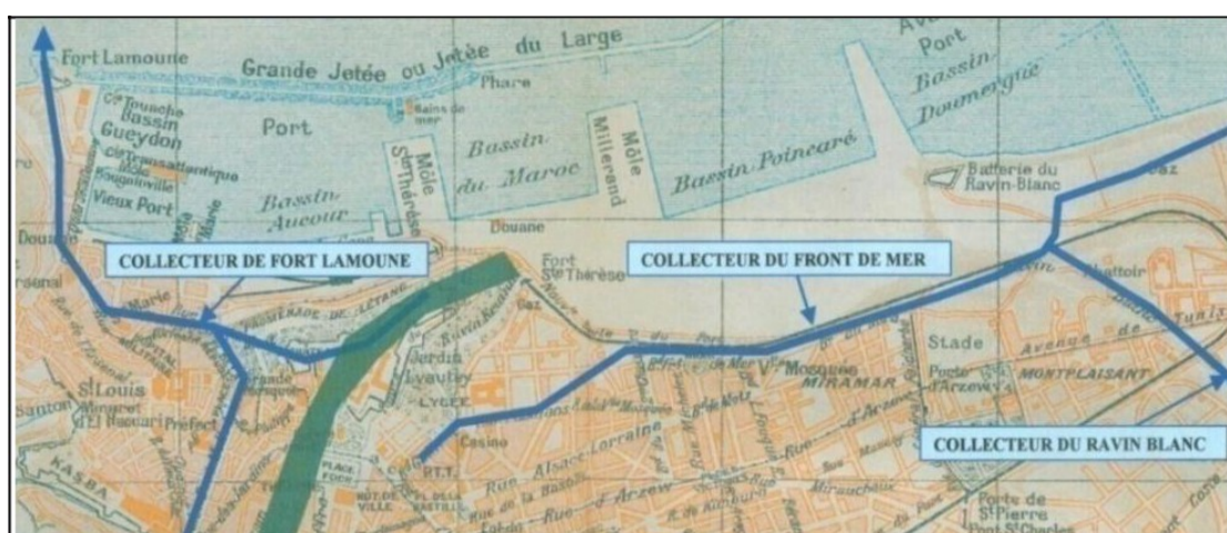
Fig. 31 - Drainage par ovoïdes des eaux souterraines et superficielles des ravins de la baie de Saint Thérèse vers l'Est d'Oran (Somatre, 2005).
