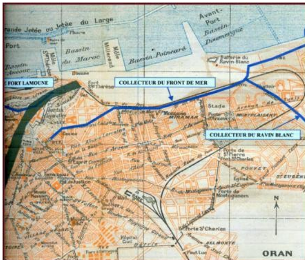
Fig. 19 - Drainage par collecteurs (ovoïdes) des eaux superficielles et souterraines des ravins de la baie vers l'Est d'Oran (Somatre, 2005)
