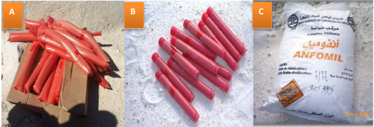
Photo n°08 : les différents explosifs utilisés pour abattre le gypse.
