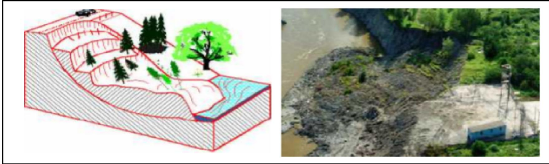
Figure 10: Le glissement rotationnel complexe a): Mécanisme d'un glissement Rotationnel b) : Exemple d'un glissement rotationnel multiple en bordure de la rivière Chicoutimi. Complexé (Bali O. et all, 2018).
