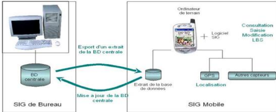
Fig.I.2 : Architecture et interaction entre un SIG de bureau et un SIG mobile [3]
