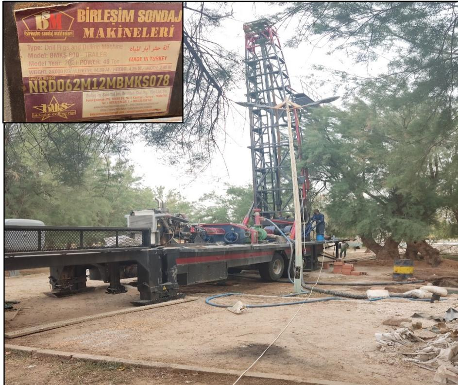
Figure 11 : L'appareil de forage rotary sur le site
