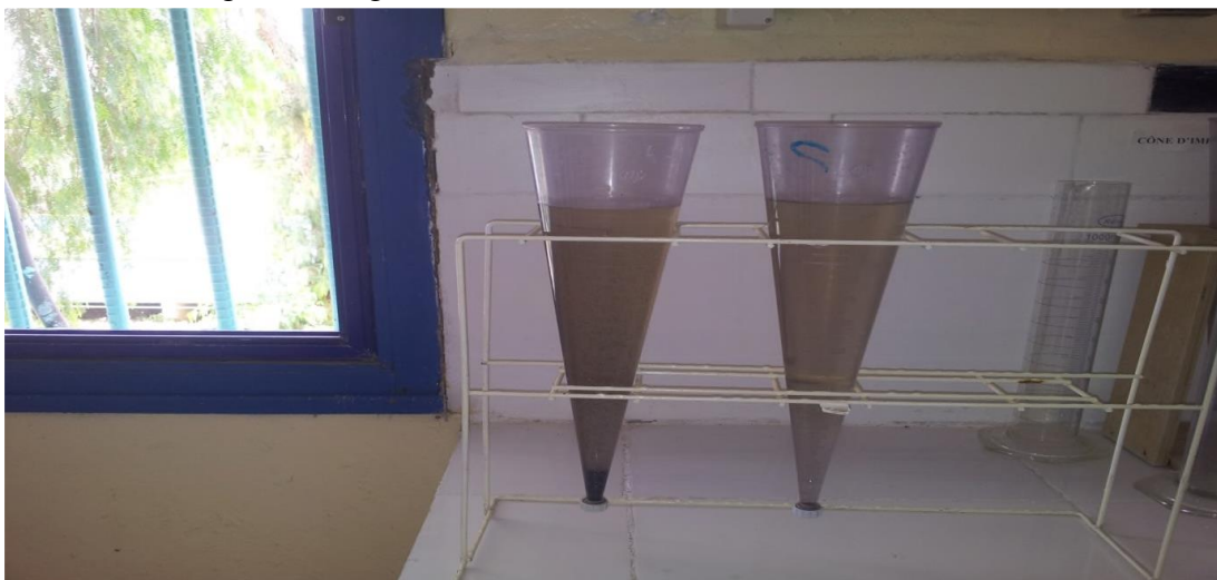
Figure .35 : Cônes D'imhoff
