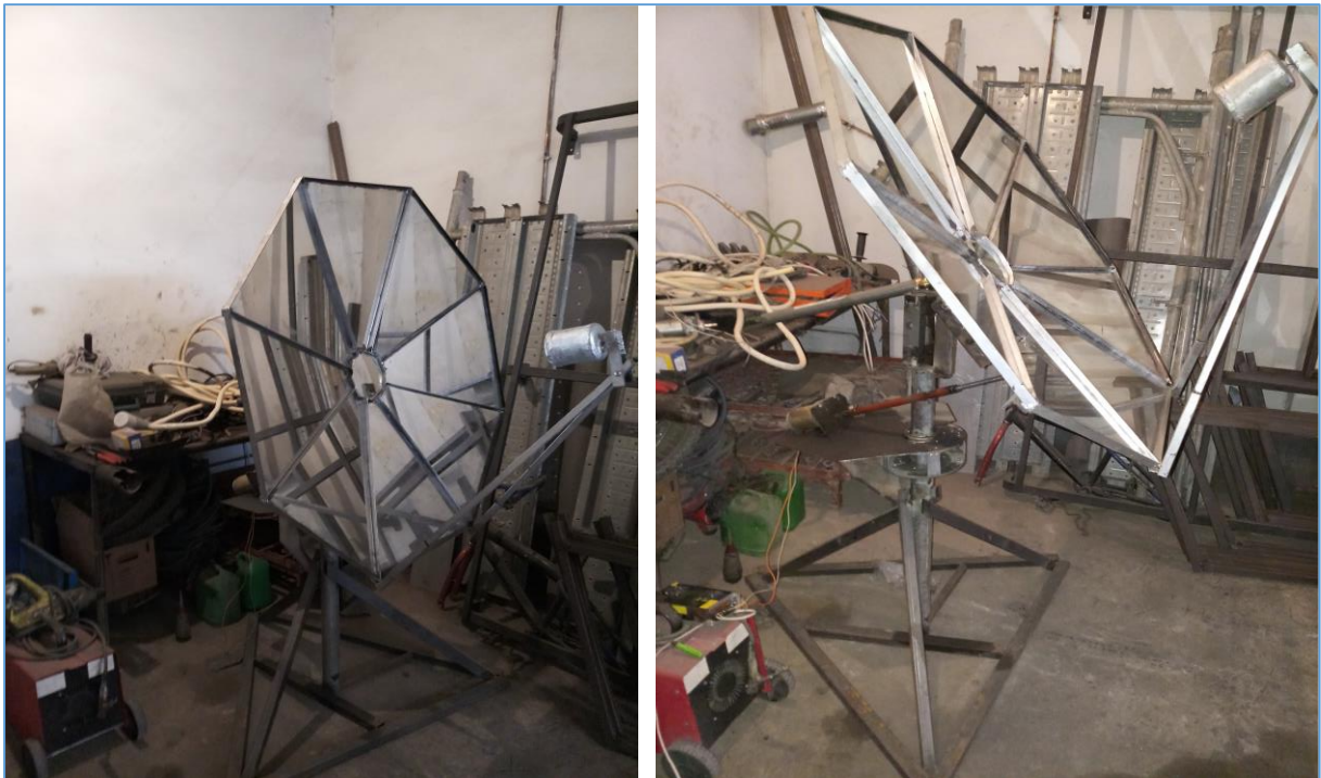
Figure 4.13 : Le système parabolique réalisé.
