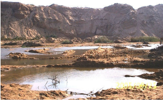
الصورة (06) : استخراج الرمال إلى ما تحت مستوى أو منسوب مياه البحر (المصدر : غضباني ط. 2005/09/25)
