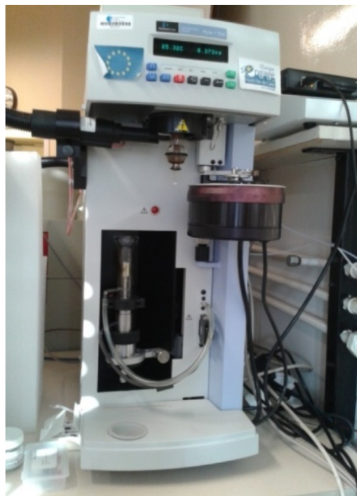
Figure III.8 Appareil d'analyse thermogravimétrique (PYRIS 1 Perkin Elmer). (Unité Matériaux Et Transformations-CNRS UMR 8207-Université Lille 1)
