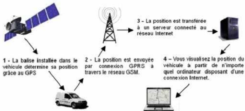
La figure 6 Explication du fonctionnement d'un système de géolocalisation
