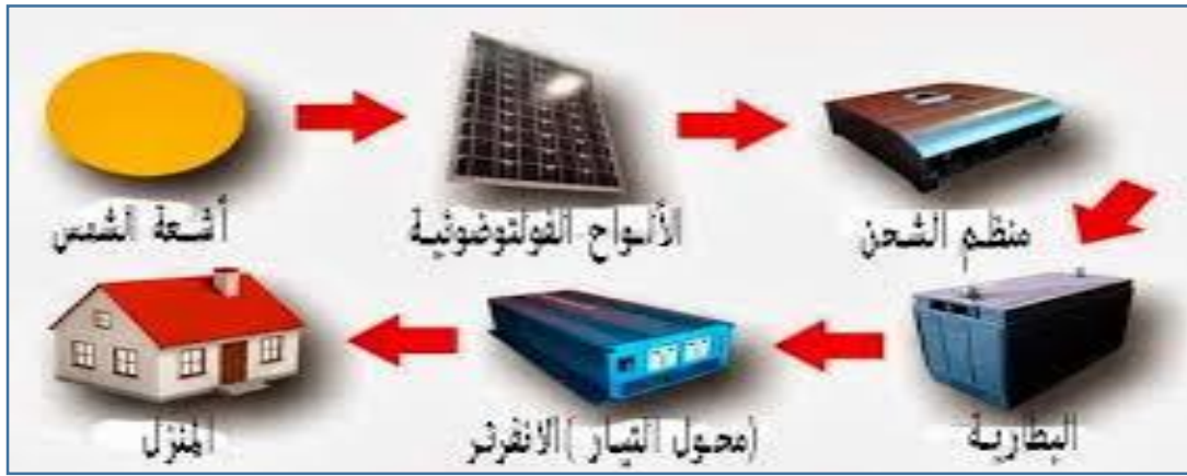
شكل رقم 13: نموذج مبسط لطريقة عمل الألواح الفولتوضوئية.
