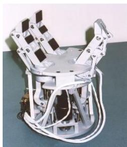
Figure I.2 Main robotique à 10 ddl
