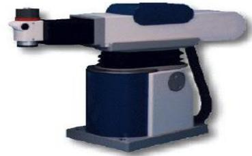
Figure I.5 : Coordonnées cylindriques (Exemple : Seiko RT3300 Robot).
