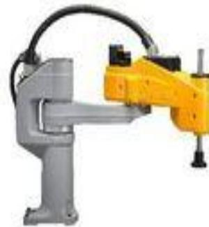
Figure. I.8 : Robot SCARA ( Exemple : Robot SCARA TS80 - STÄUBLI)
