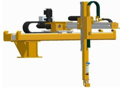
Figure I.4 : Coordonnées cartésiennes. (Exemple : Robot CHAVERIAT )
