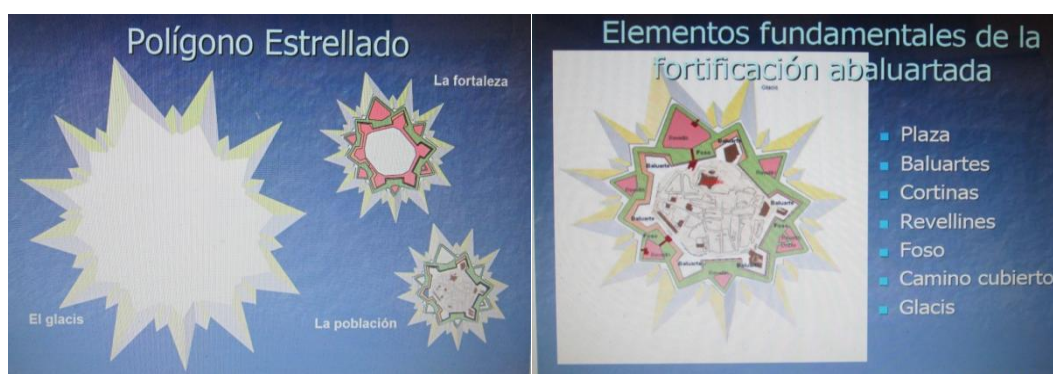
Fig. 1-2: dibujos donde se puede los diferentes elementos que constituyen la fortificación abaluartada. Tomados de LUIS CALABUIG, Á. de. (2007). Glosario de términos de fortificación en el contexto de la fortaleza de Almeida. Ciudad Rodrigo: II jornadas de Arquitectura Abaluartada. Comemorações de Cerco de Almeida.
