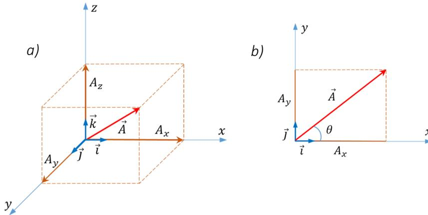
Figure 2.2 Représentation géométrique d'un vecteur : a) dans l'espace, b) dans le plan
