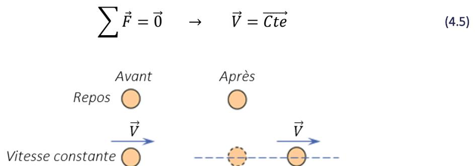
Figure 4.9 Le principe de l'inertie
