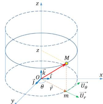
Figure 3.4 Représentation du vecteur position en coordonnées cylindriques
