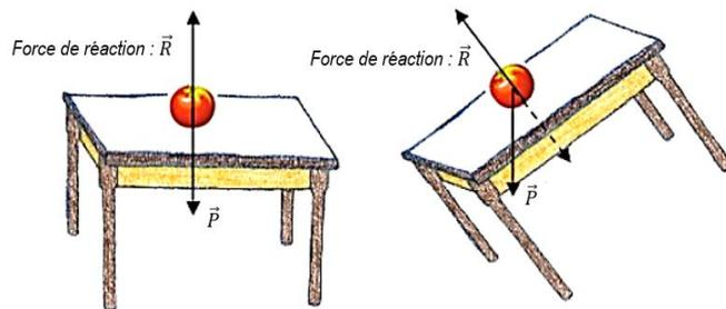
Figure 4.4 Représentation de la force de contact
