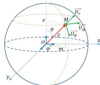
Figure 3.5 Représentation du vecteur position en coordonnées sphériques
