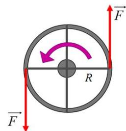
Figure 4.11 Couple de force appliqué sur un volant
