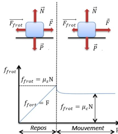
Figure 4.8 Représentation de la force de frottement statique et cinétique
