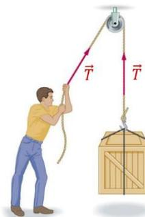
Figure 4.6 Représentation de la force de tension d'un fil
