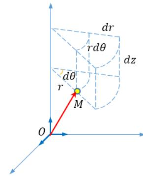
Figure 3.11 Variation du vecteur position en coordonnées cylindriques
