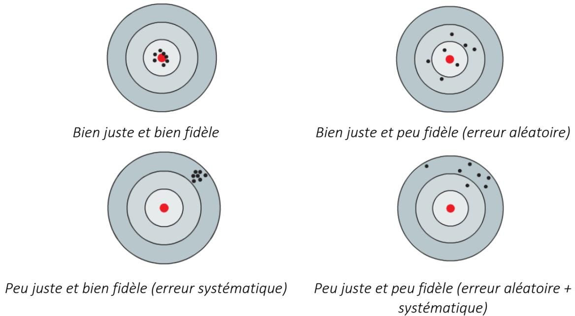
Figure 1.2 Représentation schématique de l'erreur aléatoire et de l'erreur systématique
