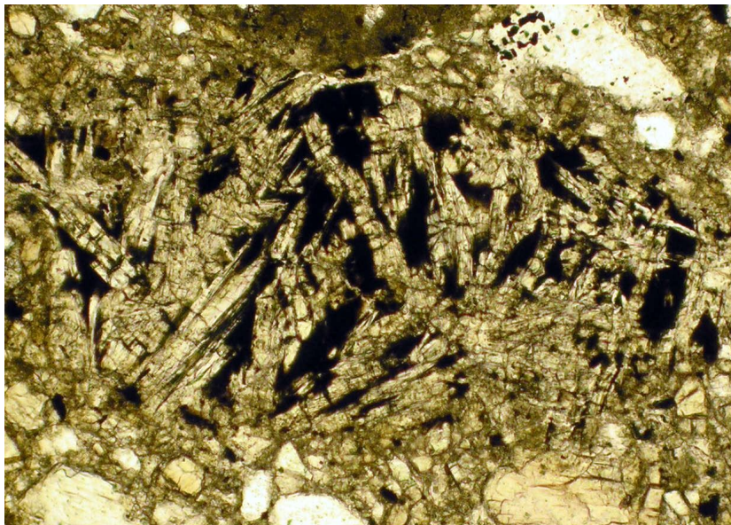
Fig.70 : Fragment d'eucrite non métamorphisée. La présence du verre sombre est bien visible (LPA).
