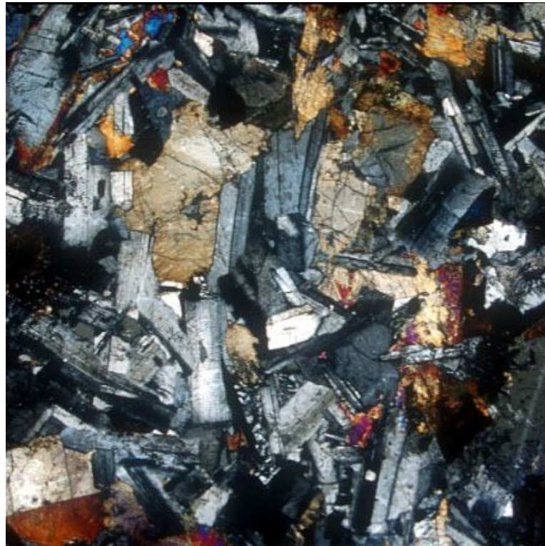
Fig. 4 : Plagioclases, Cpx et Opx dans le gabbro étudié (LPA, x25).
