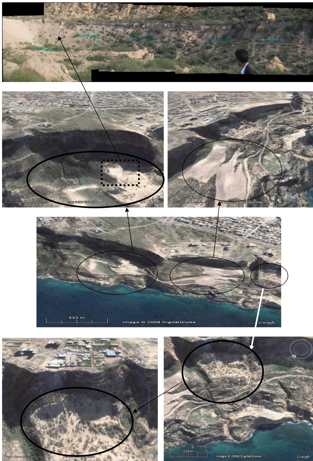
Fig.213 : suppressions partielles de la butée en pied de talus ( cercle noir : zone d'excavation de sables et grés)
