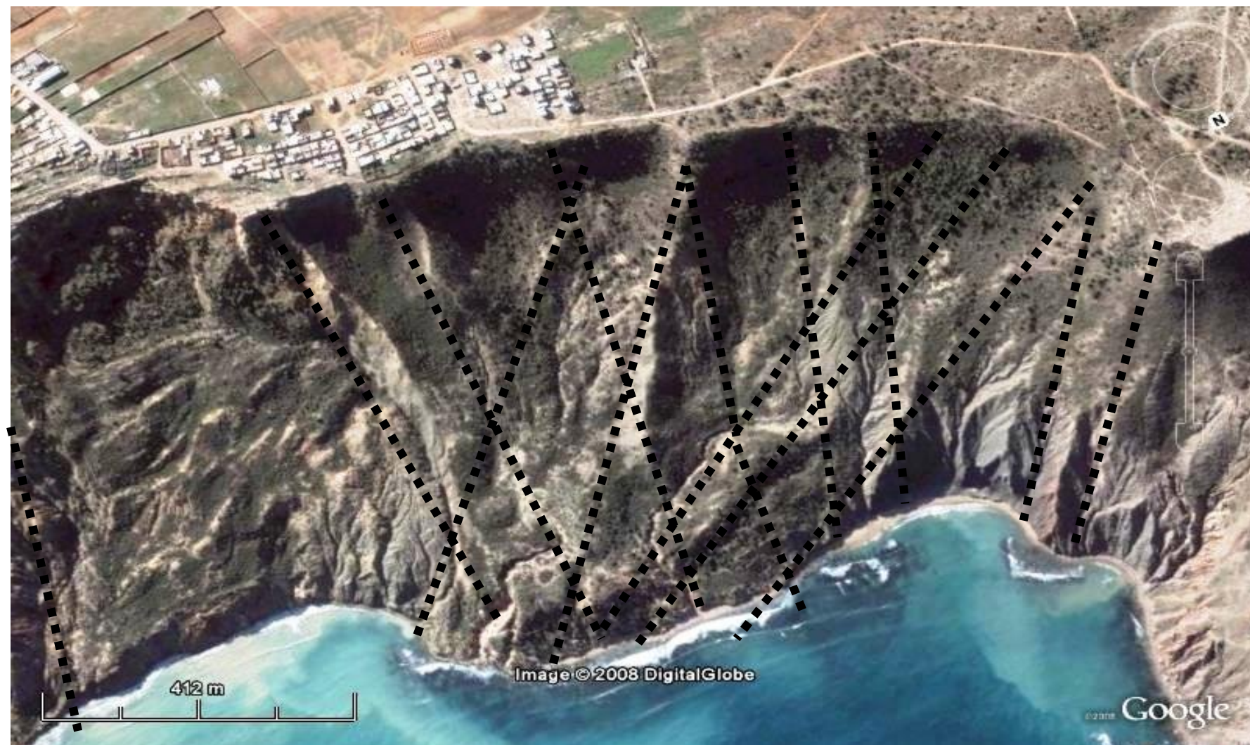
Fig.228: Failles hypothétiques déduites de l'analyse de la forme des masses glissées (Partie Ouest d'Ain Franin)
