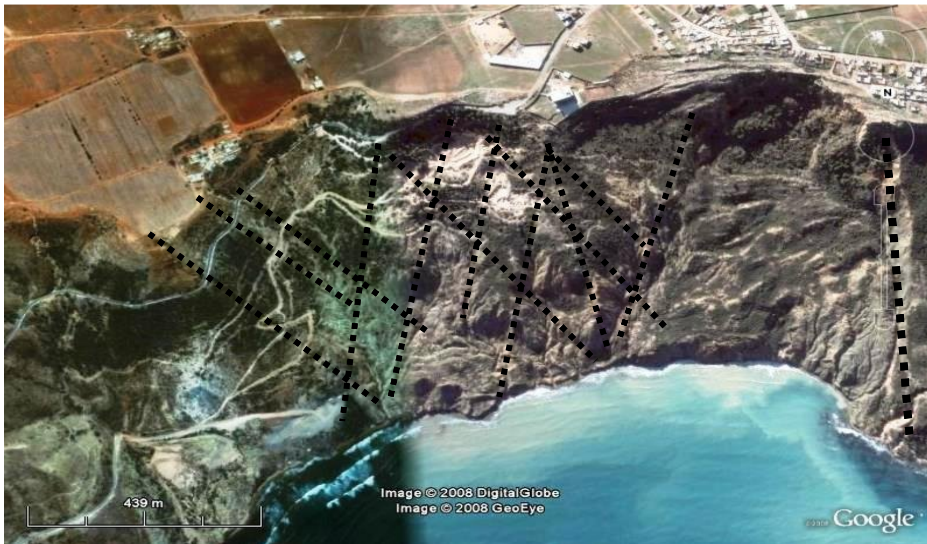
Fig. 229: Failles hypothétiques déduites de l'analyse de la forme des masses glissées (Région d'Ain Franin)
