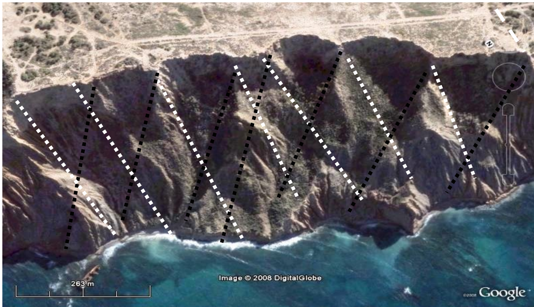
Fig.227: Failles hypothétiques déduites de l'analyse de la forme des masses glissées (S-W de la pointe Canastel)
