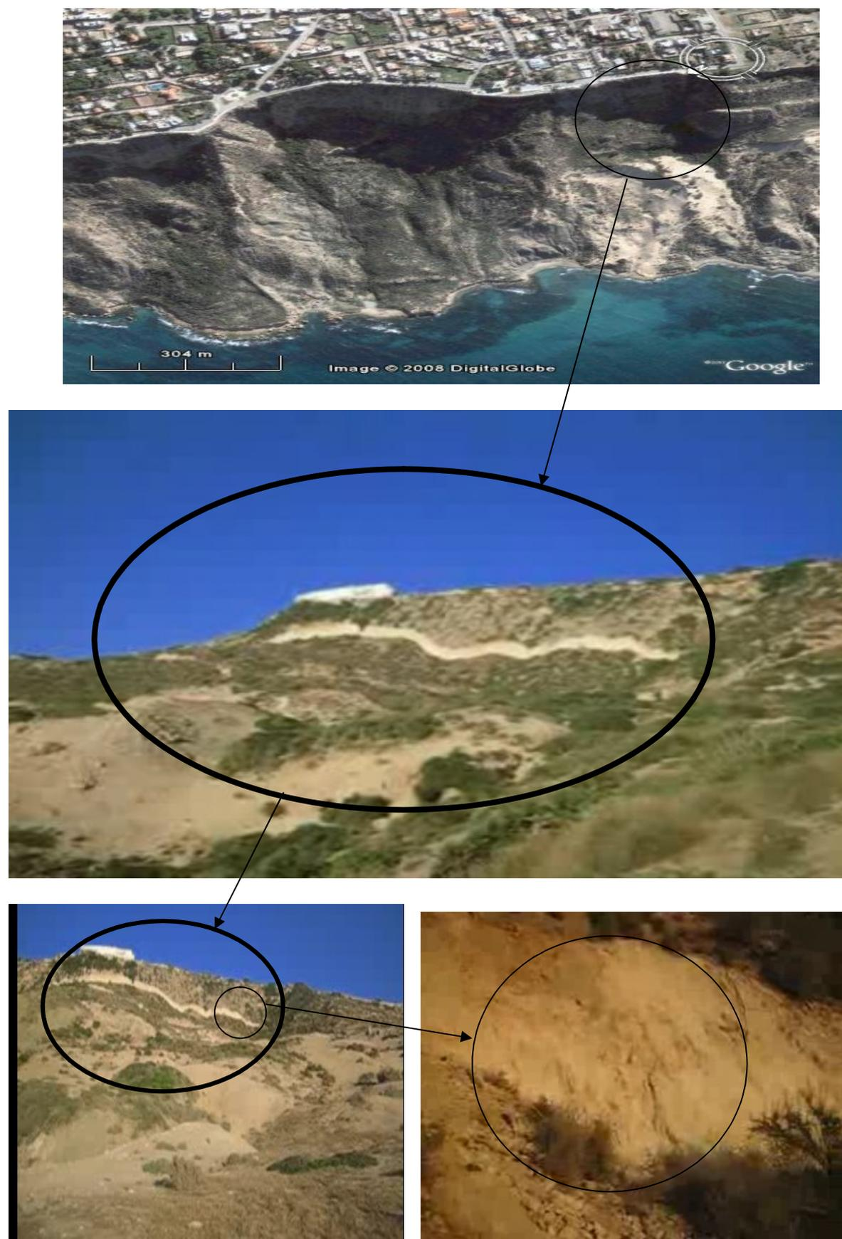
Fig.155: Glissement déclenché par le séisme d'Oran du 06/06/2008, au contrebas de Canastel
