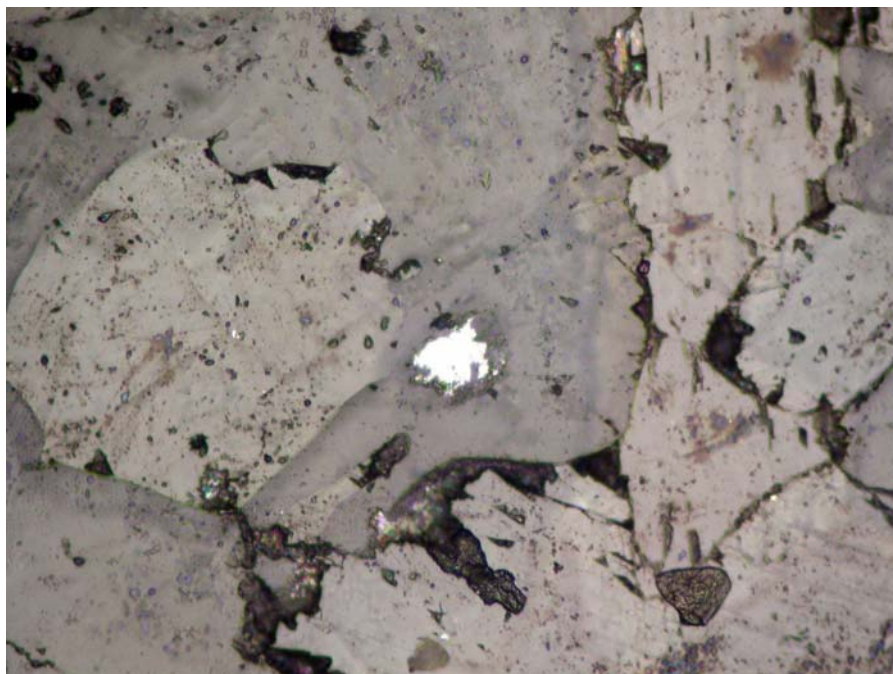
Photo 10 : Cristaux de magnétite inclus dans une plage de néphéline (malignite, échant. EG 41). (Vue en L.R. ; 50x)
