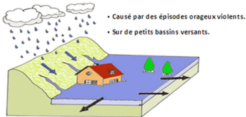
Figure 16. Inondation par crues torrentielles (Merabet A, 2006).
