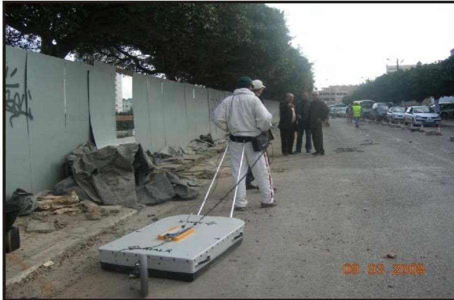
*Photo. 12- photo montre l'utilisation du géoradar.*
