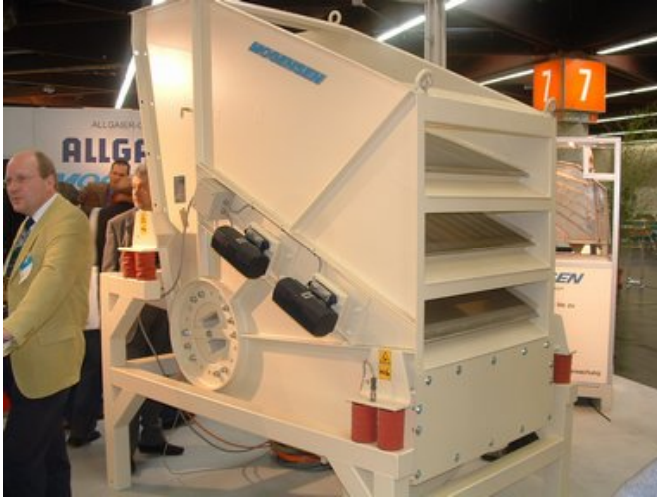
الشكل (5 - 5) فارزات Cribles حديثة من صنع ألماني
