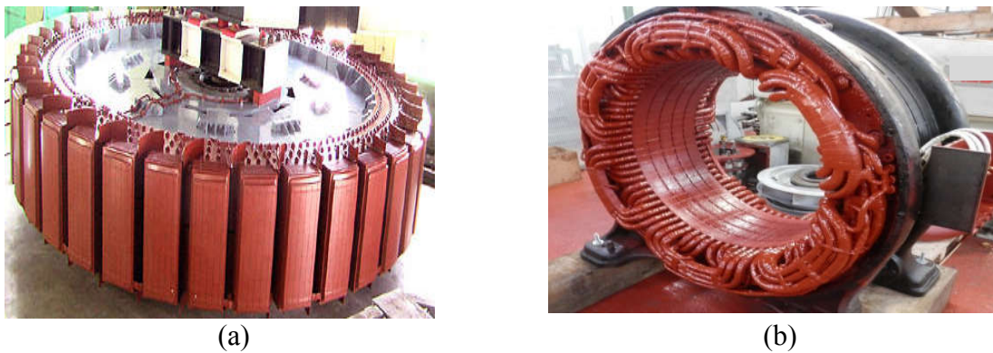
Figure A.3 : Alternateur de centrale hydraulique :
