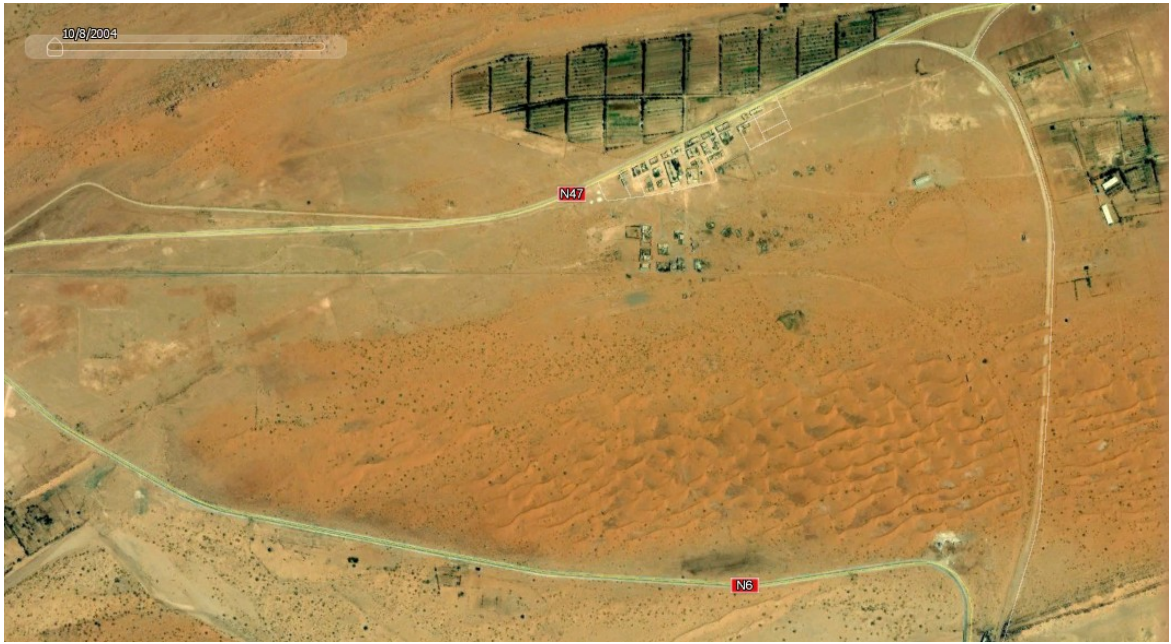
Image 5 : Problème d'ensablement d'une route et de la voie ferrée situées à l'ouest de Tiout d'après image Google Earth 2004.
