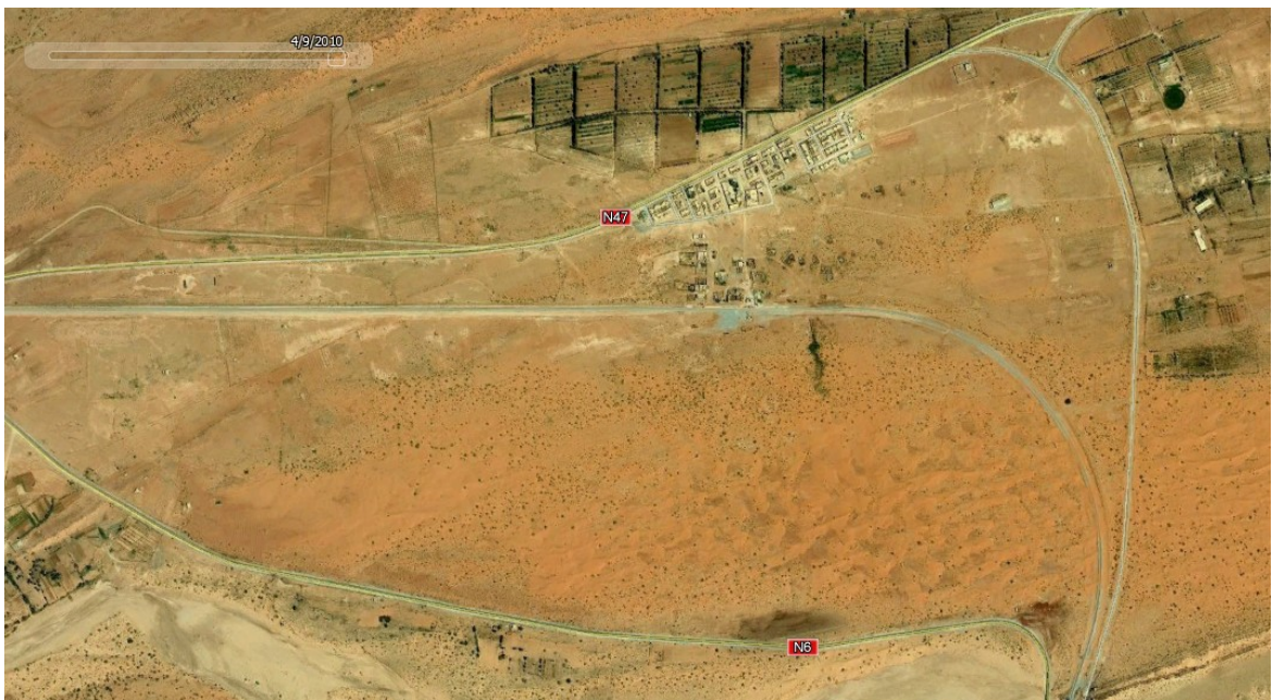
Image 6 : Problème d'ensablement d'une route et de la nouvelle voie ferrée situées à l'ouest de Tiout d'après image Google Earth 2010.
