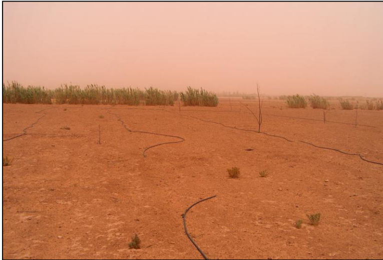
الصورة رقم (37) : تلف أنابيب السقي، لعدم تحملها للظروف الطبيعية القاسية للمنطقة. -بلدية عين خليل- 2005/06/01
