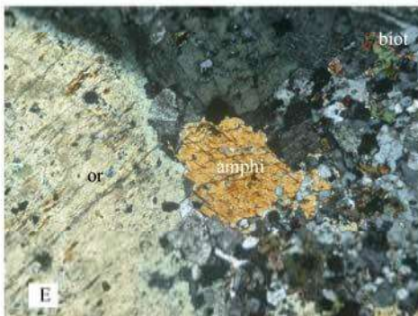
photo E: les amphiboles et les orthoses forment des porphyres entourés par une matrice microcristalline, composée par du plagioclase, de l'orthose, de la biotite et du quartz (granodiorite EG26) LPAX50
