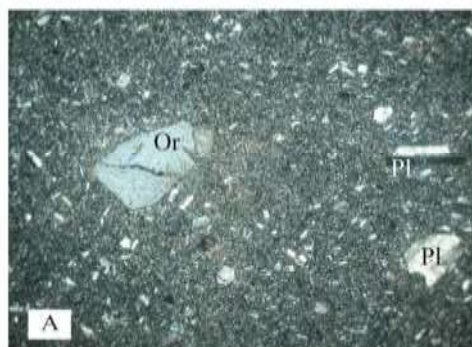
photo A: texture microlitique porphyrique de la coulée dacitique EG1, les phénocristaux de plagioclase, d'orthose et de quartz baignent dans un verre volcanique recristallisé
