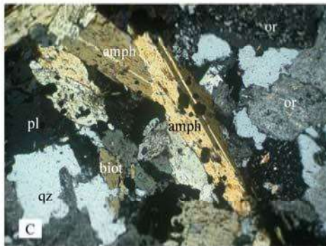
photo C: texture grenue du granodiorite EG4, les amphiboles allongées et maclées h1, sont plus fréquentes que les biotites LPAX25
