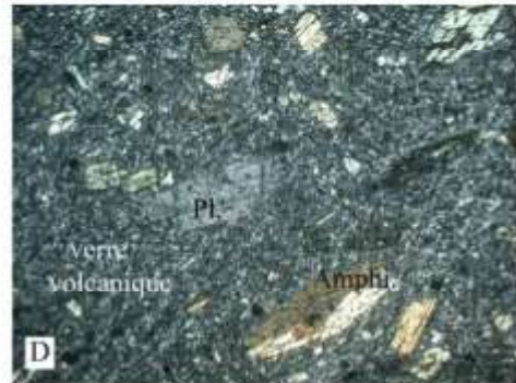
Photo D: texture microlitique porphyrique de la coulée EG22, les phénocristaux d'amphiboles losangiques et mâclé, ainsi que les plagioclases baignent dans une mésostase microcristalline recristallisée où quelques minéraux opaques tardif (sulfures) apparaissent
