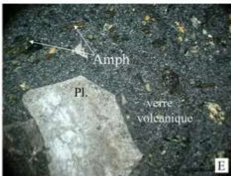
Photo C: andésite à amphibole (EG22), le phénocrystal d'amphibole est corrodé par une chlorite se propageant au niveau des clivages, le verre volcanique est assez recristallisé, LPAx25
