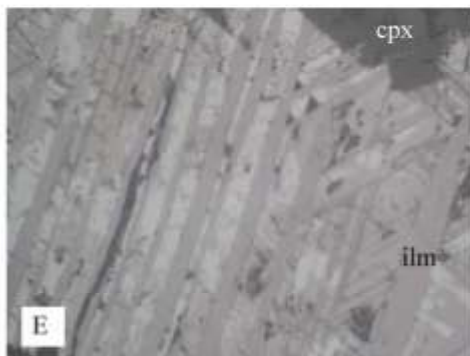
photo E: ilménite (ilm) plus fréquente en inclusions dans le gabbro dioritique EG34, lumière réfléchie X500
